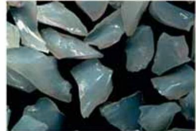
Neue Generation von SG Korn. Schärfere Kanten ermöglichen einen aggressiven Abtrag bei geringerer Kraftaufwendung.
