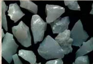
Aktuelle Generation von keramischem Schleifkorn.
