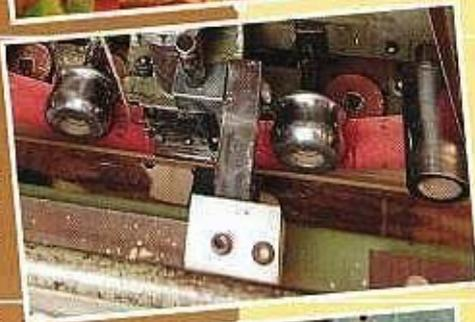
Zum Schleifen von stark geformten Profilen auf Profilschleifmaschinen
