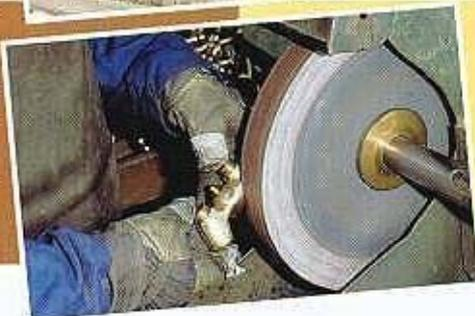
Feinbearbeitung von stark geformten Werkstücken aus Metall
