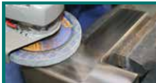
Reduzierung der Oberflächenrauigkeit. Erzielen einer "optischen" Oberfläche, Vorbereitung zum Polieren.
