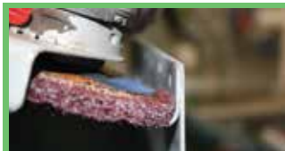
Entgraten, Kanten verrunden, Kanten brechen.
