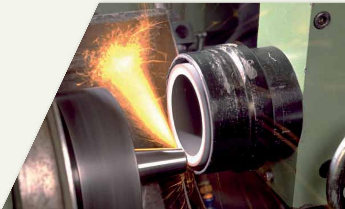
Schleifzylinder sind relativ weich und haben eine dünne Kontaktzone - sie werden normalerweise mit einem Futter gespannt oder sind auf einer Trägerplatte befestigt. Das Werkstück ist auf einem Pendeltisch oder einem im Uhrzeigersinn drehenden Rundtisch aufgespannt. Zur Sicherheit sind Zylinder mit Bandagen aus sehr reißfestem Draht versehen.
